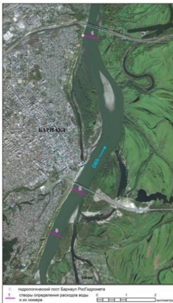
Рисунок 1.3 – Створы определения расхода воды ИВЭП в 2016 – 2019 гг.
