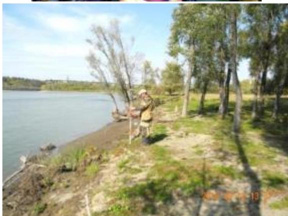
б) съемка пространственного положения бровки берега подвижным компонентом GPS-системы Leica Sr-20 («ровером»).
