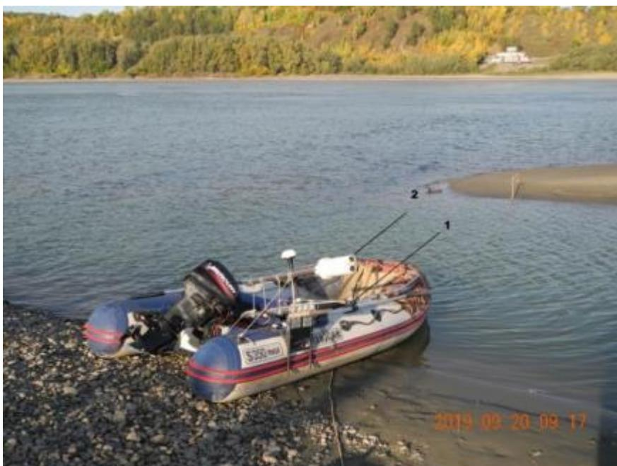
1 – излучатель эхолота Lowerance LMS-480; 2 – акустический доплеровский профилограф-расходомер Sontek M9 аппаратно-программного комплекса Sontek RiverSurveyor Live. На заднем плане – здание водозабора №1.
