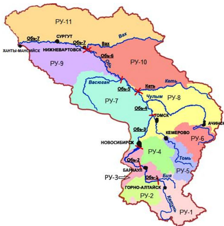
Рисунок 10 – Схема расчетных участков Верхней и Средней Оби: РУ-3 – номер расчетного участка (участки выделены цветом); Обь-3 – название спецучастка; — — — — — граничный створ спецучастка.
