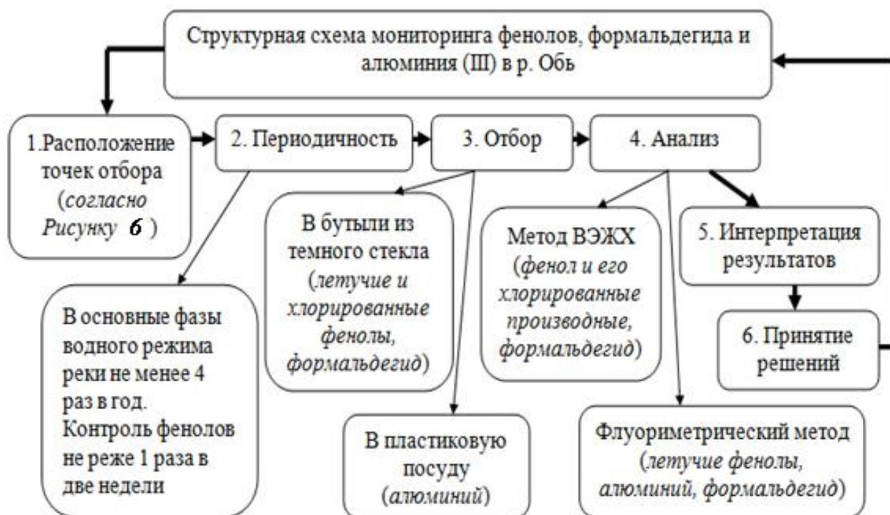
Рис. 5 Структурная схема мониторинга фенолов, формальдегида и алюминия (III) в р. Обь в районе г. Барнаула
