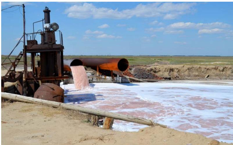
*Рис. 3.22.* Закачка воды из Кучукского озера в Селитренное озеро в процессе производства мирабилита
