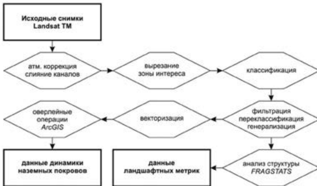
Рисунок 1. Алгоритм анализа пространственно-временных изменений наземных покровов на модельном участке
